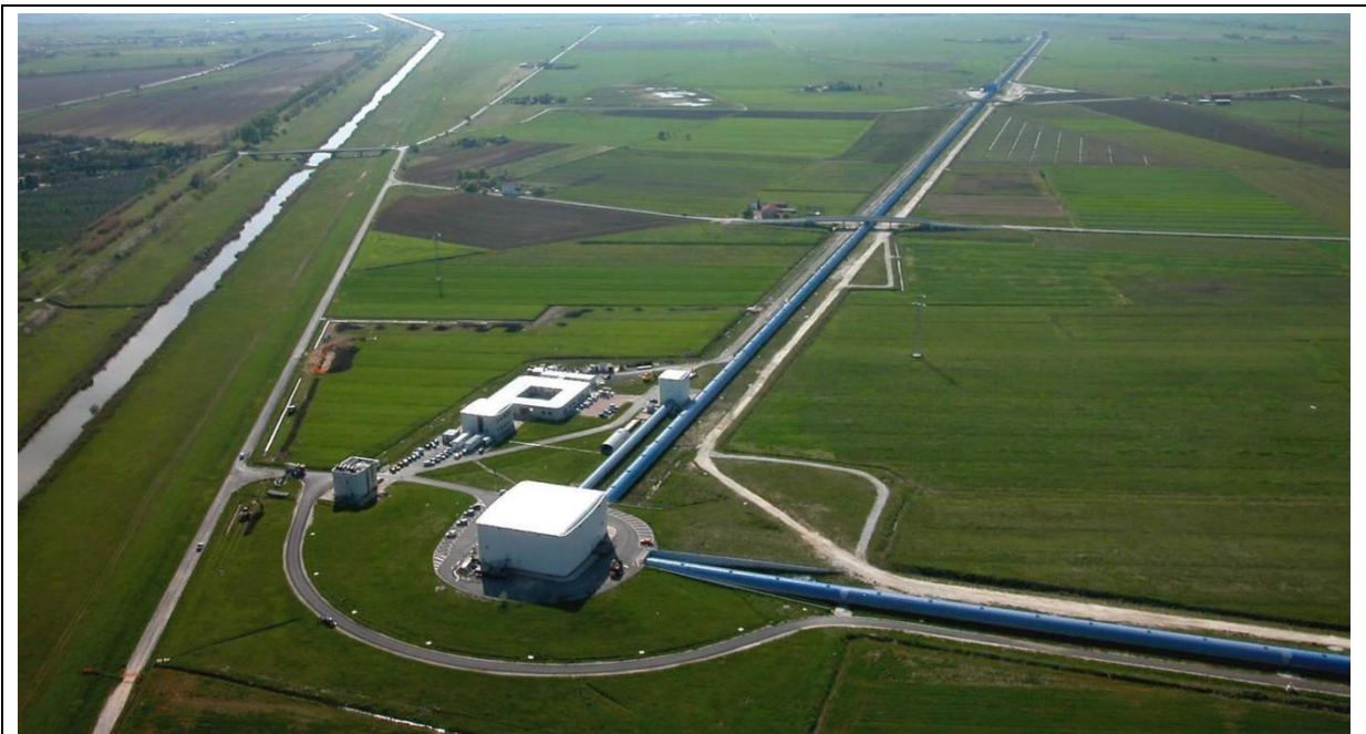
Fig 4: Le détecteur d'ondes gravitationnelles Virgo en Italie avec ses deux bras en forme de L de 3km de longueur chacun.
